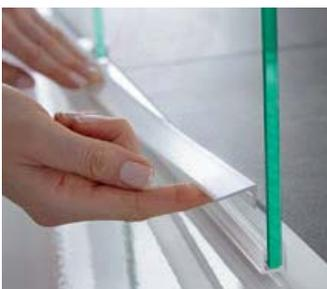
Horizontale Wasserabweiser unten an den Türen gehören zum Standardlieferumfang. Der Wasserabweiser wird zweiteilig ausgeführt und kann so zum Reinigen oder zum Austausch sehr einfach auch vom Nutzer entfernt und wieder montiert werden. Ebenso sind alle optionalen Dichtleisten zur Reinigung einfach entfernbar und auch austauschbar.
