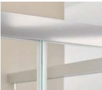
Bei Verwendung von filigranen, vertikalen Dichtleisten zwischen Festverglasung und Schiebeflügel kann der Scheibenüberlapp auf 5 mm reduziert werden. Seitlich neben jeder Dichtleiste kann dann problemlos mit dem Wasserabzieher gewischt werden.
